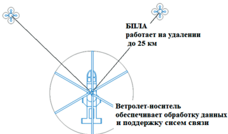
Рисунок 5. Использование вертолета-носителя в качестве передвижного командно-логистического центра
