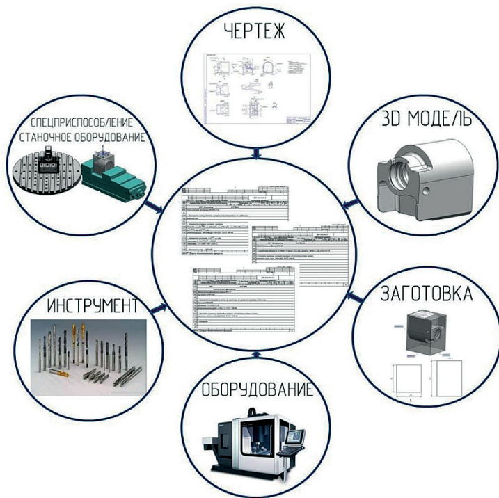
Рисунок 7. Основные базы данных в СУБД «ПОЛИНОМ:МДМ» для технологического проектирования в САПР ТП «ВЕРТИКАЛЬ»
