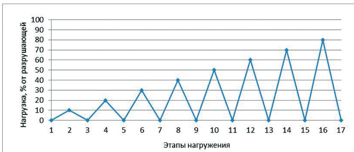
Рисунок 25. Программа нагружения испытываемых образцов
