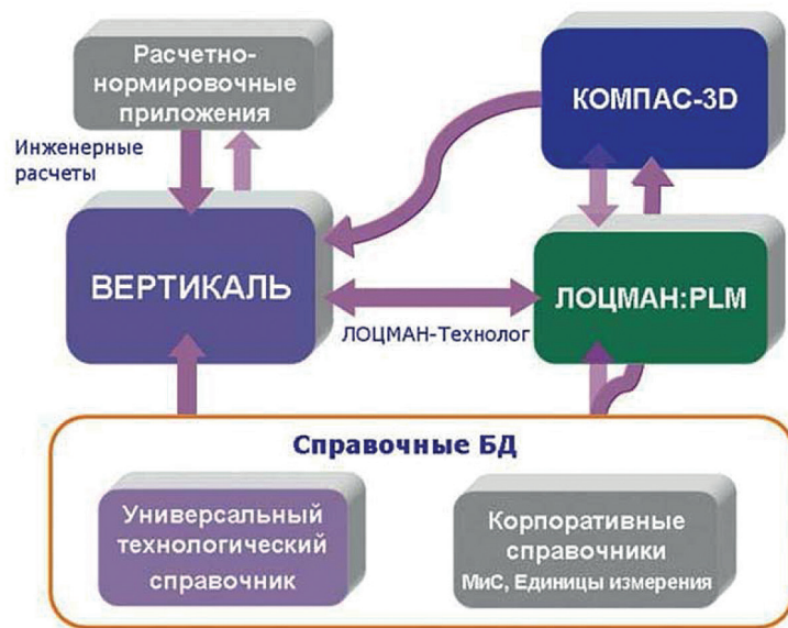
Рисунок 8. Интеграция и взаимодействие элементов комплекса «АСКОН»
