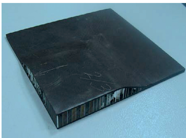
Рисунок 20. Образец сотоблока закрылка
