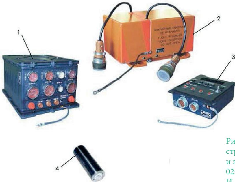
Рисунок 2. Бортовое устройство регистрации параметрической информации и записи звуковой информации РПИ-2-02: 1 – БСПИ 2-02; 2 – ЗБН-2М; 3 – ПУ-И-2М; 4 – ПАМ-6к
