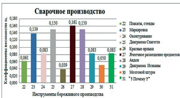
Рисунок 5. Коэффициенты весомости для инструментов БП, применяемых в процессе сварочного производства
