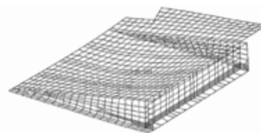
Рис. 2. Деформированное состояние дефлектора изд. Бе-200 от клеточной нагрузки воды, приложенной в его центральной части
