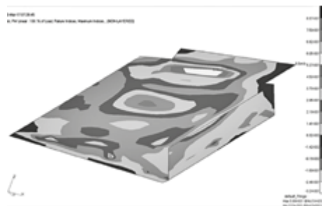
Рис. 3. Поле индекса разрушения по поверхности дефлектора изд. Бе-200 от клеточной нагрузки, приложенной в его консольной части
