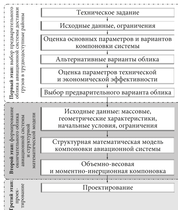
Рис. 3. Структурная схема формирования облика авиационной системы доставки грузов в труднодоступные районы
