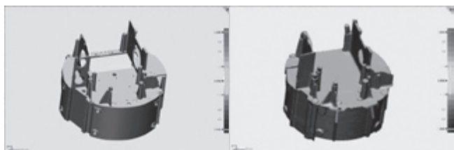
Рис. 2. Облако точек сканируемой заготовки и соответствующая ей теоретическая CAD-модель
