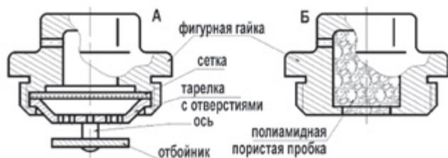
Рис. 5. Конструкция крышки до (А) и после (Б) анализа качества изделия
