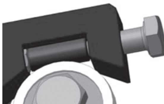
Рис. 5. Схема «ролик – ролик» на машине трения Айшингера
