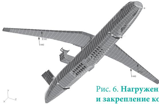
**Рис. 6. Нагружение и закрепление конечного элементной модели**
