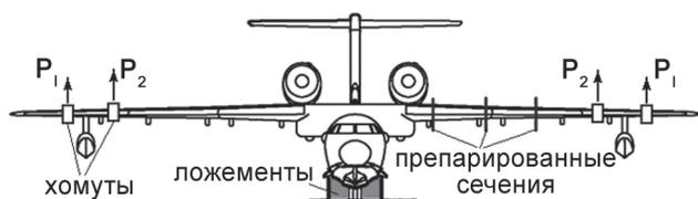
Рис. 2. Схема приложения тарировочных нагрузок к крылу самолета
