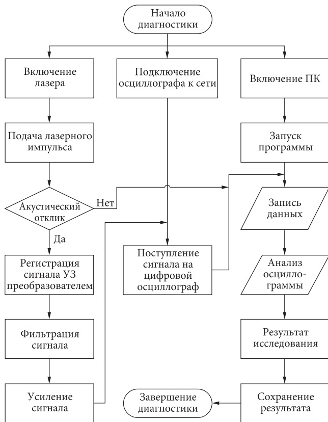
Рис. 4. Блок-схема алгоритма методики проведения проточной диагностики жидкости
