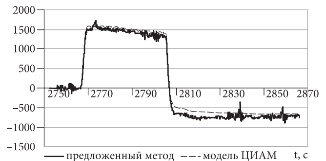
Рис. 4. Приращение эффективной (предложенным методом) и внутренней (модель ЦИАМ) тяги двигателей при ступенчатом отклонении РУД от 33° до 65° (максимал) и 17,2° (малый газ)
