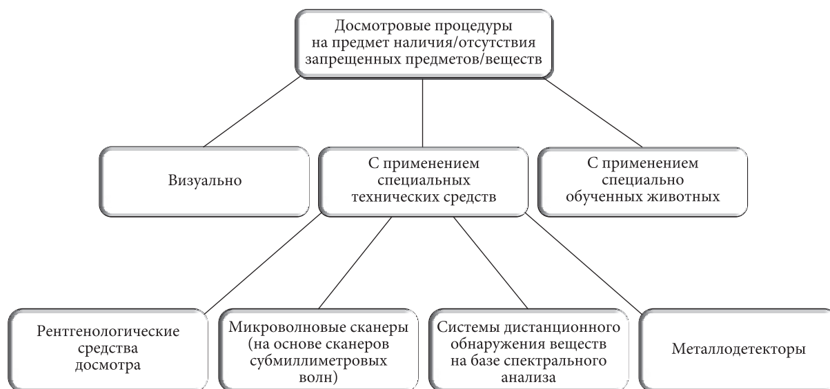
Рис. 1. Досмотровые процедуры на предмет наличия/отсутствия запрещенных предметов/веществ
