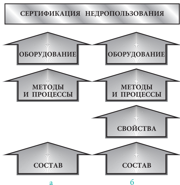
Рис. 1. Система сертификации минерального сырья а – существующая; б – предлагаемая
