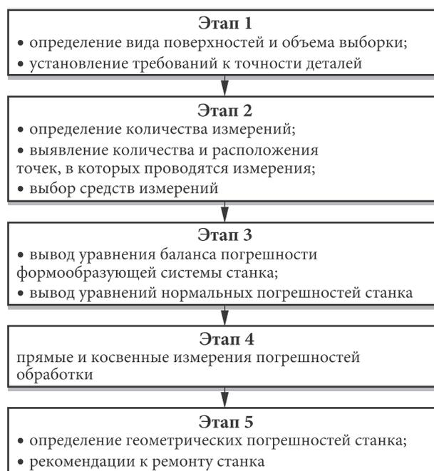
Рис. 1. Схема функциональной диагностики МРС [5]
