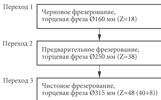
Рис. 3. Технологический процесс обработки поверхности БЦ
