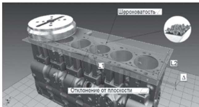
Рис. 2. Влияние отклонений формы на качество наружной поверхности
