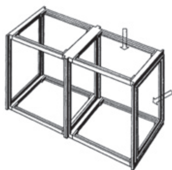
Рис. 3. Замкнутый жесткий каркас оборудования нужных габаритов
