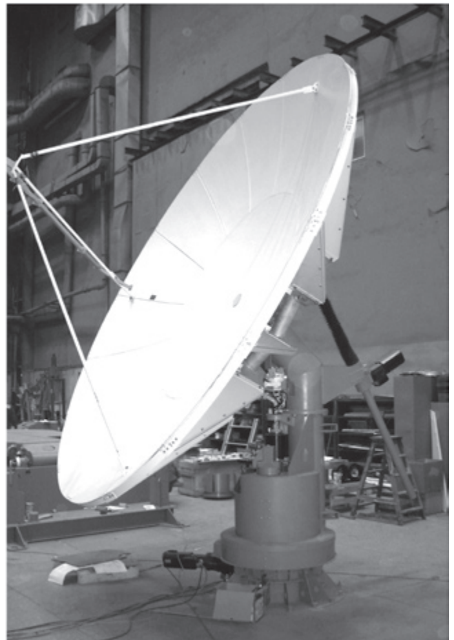
Рис. 4. Сборка антенны для метеорологической РЛС
