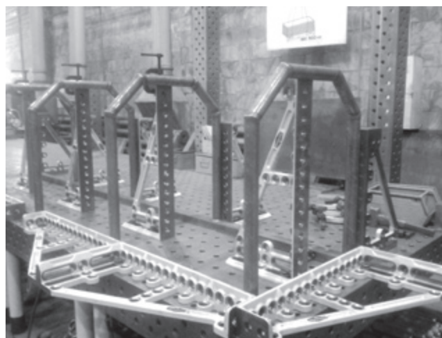
Рис. 3. Многофункциональный сборно-разборный сварочный стапель
