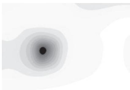
Рис. 5. Восстановленная интенсивность усредненной интерферограммы пластины с дефектом углубления
